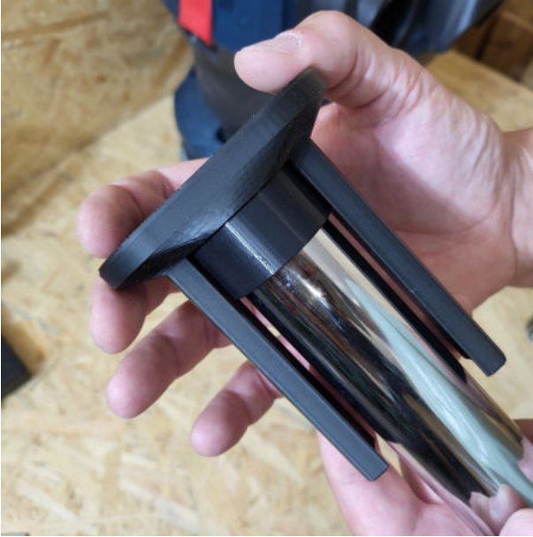
3. Die Montagehilfe auf den Rohrstopper aufsetzen.....
