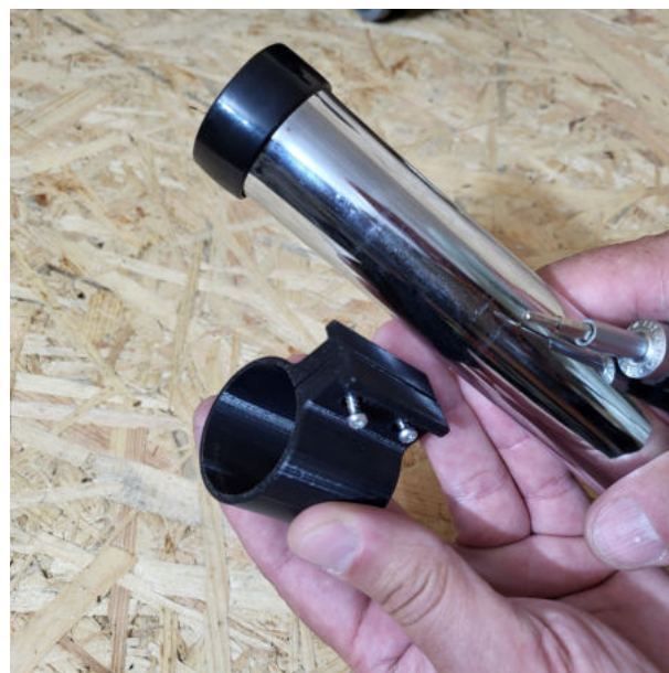
2. Die Parkklammer auf ein Saugrohr aufschieben.....
