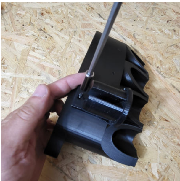
1. 35mm Werkzeughalter mit 2x 3,2x19 T10 Schrauben an Pos 1 befestigen
