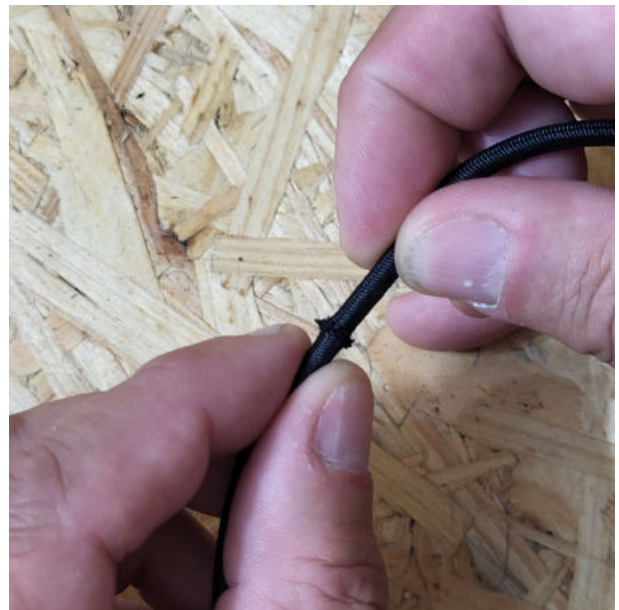
8....und die beiden Seilenden wieder verbinden.
