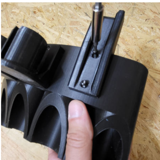
1. Den Parkhalter wie abgebildet mit 2x 3,2x19 T10 Schrauben an Pos 3 befestigen.
