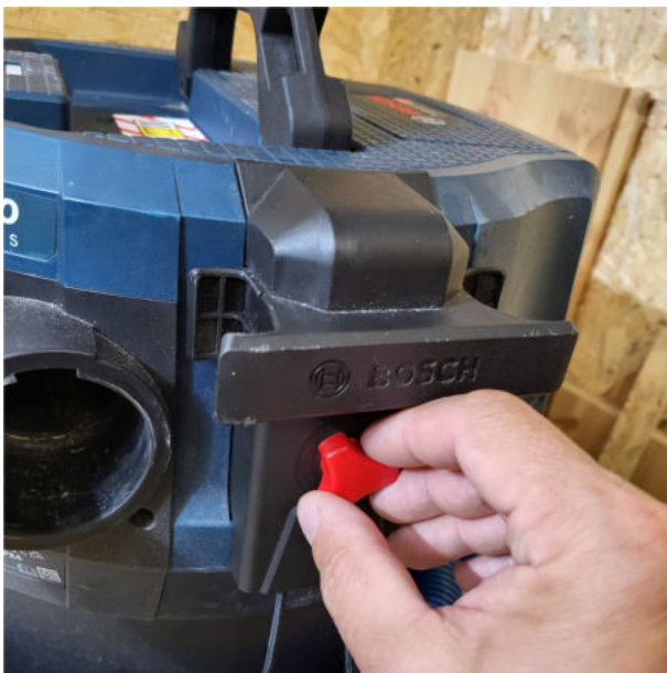
1. Bosch Zubehörhalterung entfernen
