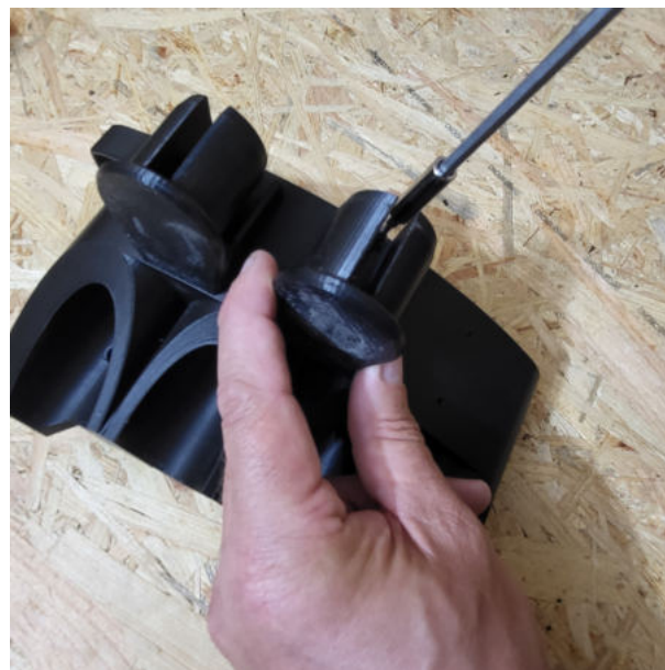
2. 35mm Werkzeughalter mit 2x 3,2x19 T10 Schrauben an Pos 2 befestigen
