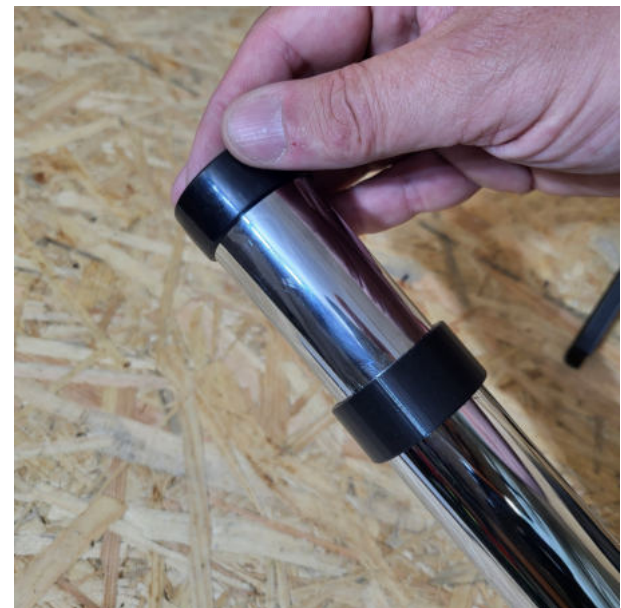
6. Die Rohrstopper sind jetzt fertig montiert.
