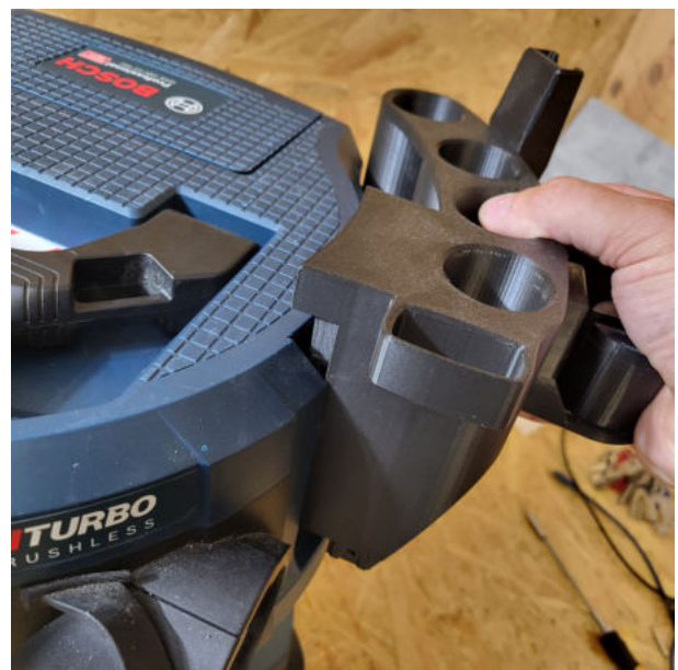
2. Zubehörträger in die Aufnahme einschieben
