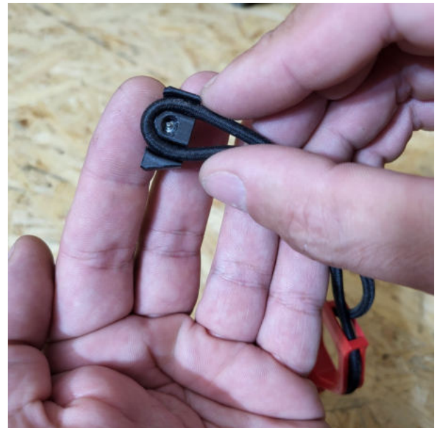
12. Das obere Schlaufenende in den Gummibandhalter legen.....
