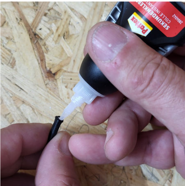
7. an ein Seilende einen Tropfen Sekundenkleber angeben....
