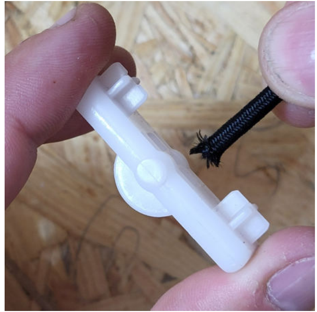
6.....und aus dem weißen Spanner herausziehen.
