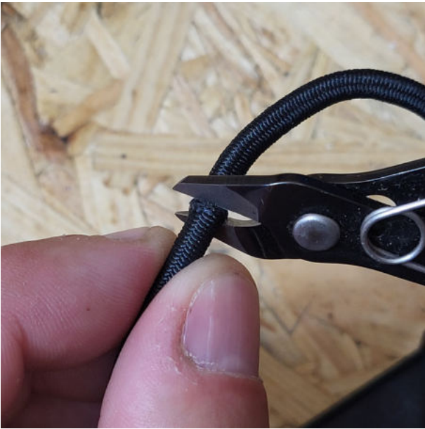
5. Das Gummiseil mit einem Seitenschneider oder einem Messer trennen.....
