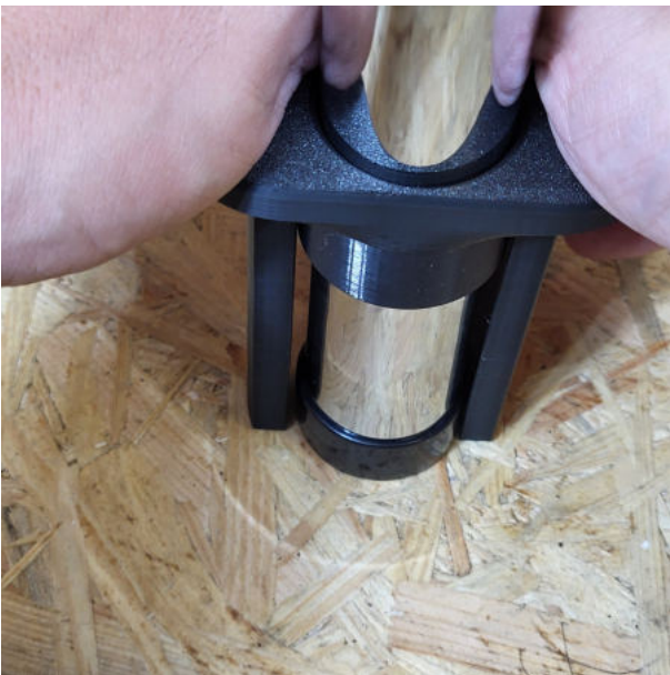
5. ...und mit beiden Händen mit der Montagehilfe den Rohrstopper nach unten drücken bis die Füße der Montagehilfe die Oberfläche berühren.
