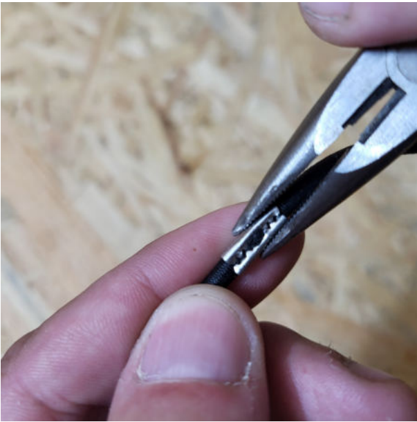
9. Die Verbinderkralle wieder über die Klebestelle legen und mit einer Zange zubiegen.
